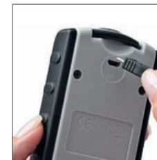
Aufladung über USB-Ladekabel mit Micro-USB-Anschluss
